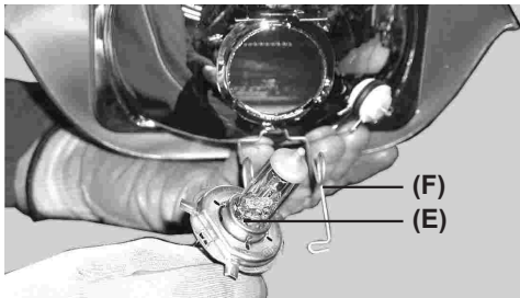
(F) Alambres de sujeción de la bombilla.
