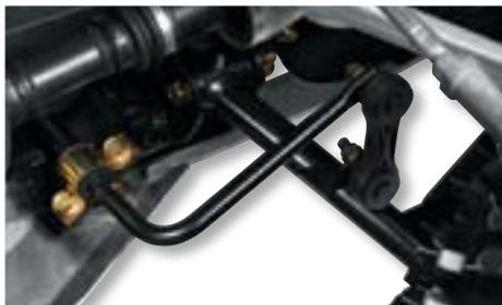
**BARRA ESTABILIZADORA DELANTERA**
